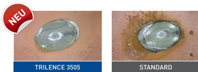
Auf einer Kupferoberfläche ist das unterschiedliche Verhalten der Rückstände bleifreier Lötdrähte gut zu erkennen. Die Trilence-Lötdrähte zeichnen sich durch das geringe Spritzverhalten aus, ihre hellen Rückstände sowie die optimale Ausbreitung.
