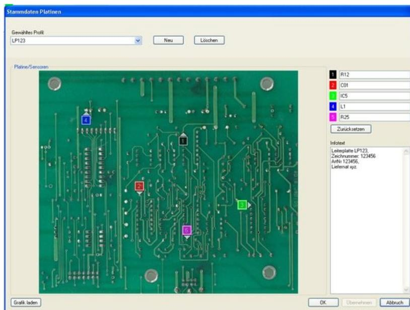
Hier können Sie Leiterplatten definieren, mit denen die Messungen durchgeführt werden. Mit dem Befehl Neu legen Sie ein neues Leiterplatten-Profil an. Mit dem Befehl Löschen wird ein bestehendes Profil gelöscht. Für ein neues Profil wird zuerst ein Name vergeben. Nachdem dieser eingegeben wurden, können Sie ein Bild Ihrer Leiterplatte mit dem Befehl Grafik laden importieren.
