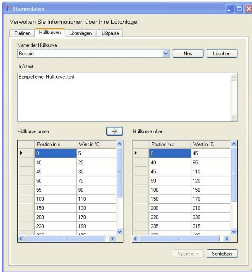
Zuerst werden die Daten „Hüllkurve unten“ eingegeben. Anschließend hat man die Möglichkeit mit dem Pfeil- Symbol die Werte für “Hüllkurve oben“ automatisch zu erzeugen. Hierzu öffnet sich ein neues Fenster, indem man die Toleranz in °C oder % angeben kann. Man kann die Werte für die „Hüllkurve oben“ aber auch manuelle eingeben oder die automatisch erzeugten Werte anschließend beliebig verändern.
